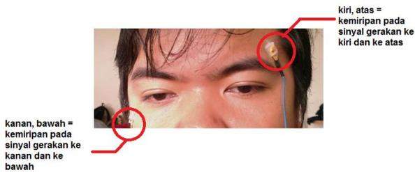
Gambar 9. Peletakan elektroda dan kesalahan pada pembacaan sinyal
